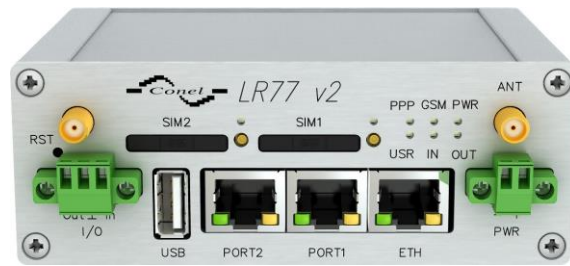
Full Version im Aluminiumgehäuse mit 2 SIM-Karten und 2 Erweiterungsports
