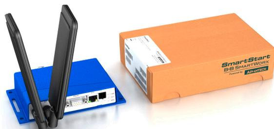
Der **SmartStart™** mit LTE Cat4 stellt die perfekte Lösung dar, um RS-232 und Ethernetbasierte Geräte mit einem Mobilfunk-Netzwerk zu verbinden. Durch den leistungsstarken Prozessor kann das komplette Spektrum an LTE Kommunikations-Möglichkeiten bedient werden, inklusive Video-Streaming und industrielle M2M und IoT Applikationen. Der interne Speicher bietet ausreichend Platz für kundenspezifische Skripts und Software-Applikationen.
