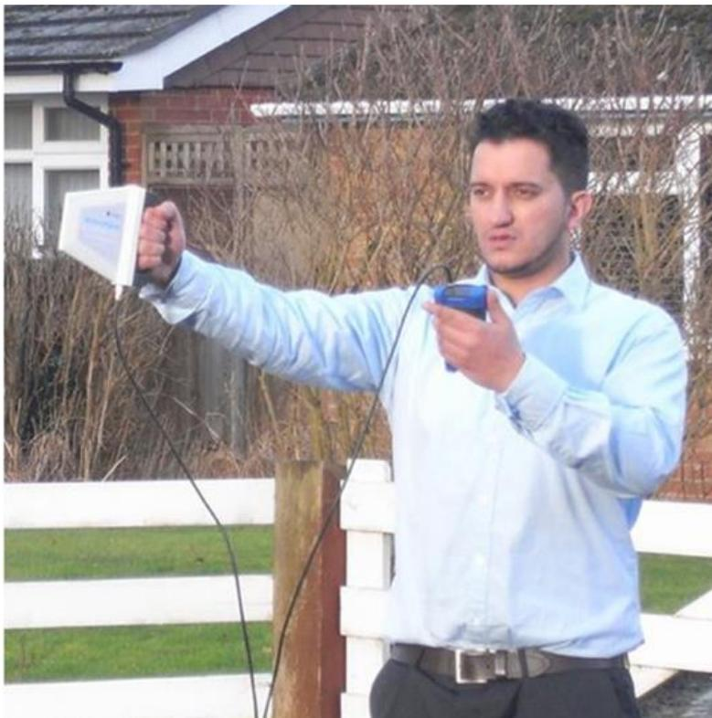
Die Antenne verfügt über einen Griff, welcher es ermöglicht in der einen Hand die Antenne zu halten und in der anderen Hand den Signalscanner. So ist es auch für eine Einzelperson bequem möglich, den Horizont mit der Antenne abzutasten und sich gleichzeitig die Signalstärke aus der jeweiligen Richtung anzeigen zu lassen.
